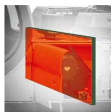
FIREWALL INSTALLED BETWEEN THE ENGINE AND PUMP
